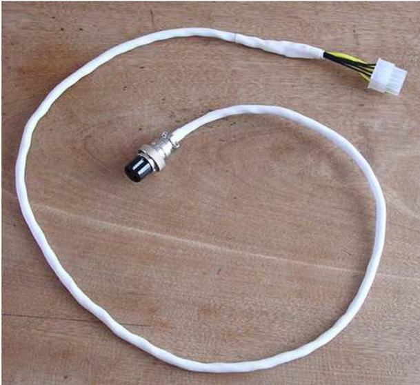
CPU用ケーブルはマザーボード側の8ピンのコネクタと、電源装置側にMICメス2ピンのプラグで構成しています。使用中の脱落を防止するため、しっかりとネジでとめて下さい。
