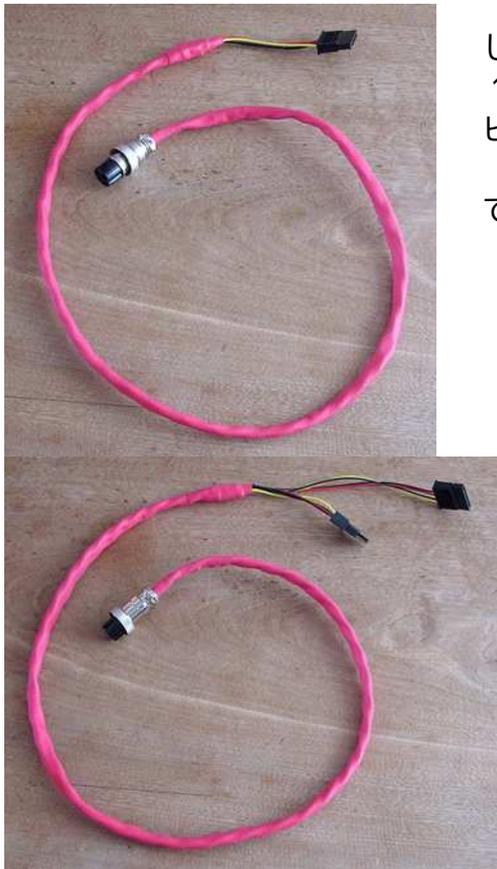
HDD/SSD用ケーブルは2種類2本を用意しました。SATA電源プラグが2個ついたケーブルと1個のケーブルです。電源装置側はMICメス4ピンのプラグです。
