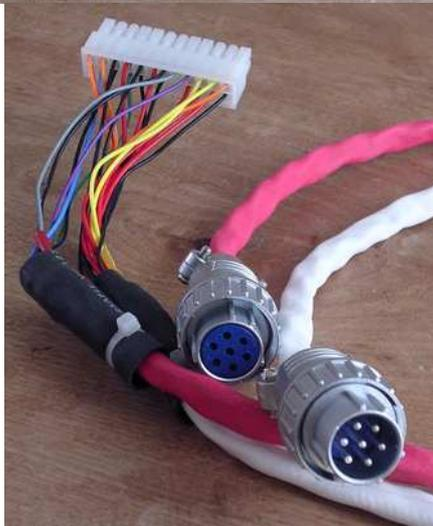
ATX24 ピン用のケーブルは、マザーボード側の 24 ピンのコネクタと 2 本のケーブルで構成しています。誤接続がないように、電源装置側のプラグをオスとメスで区別しました。
