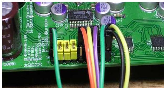
図7 ピンヘッダーを利用した接続例
