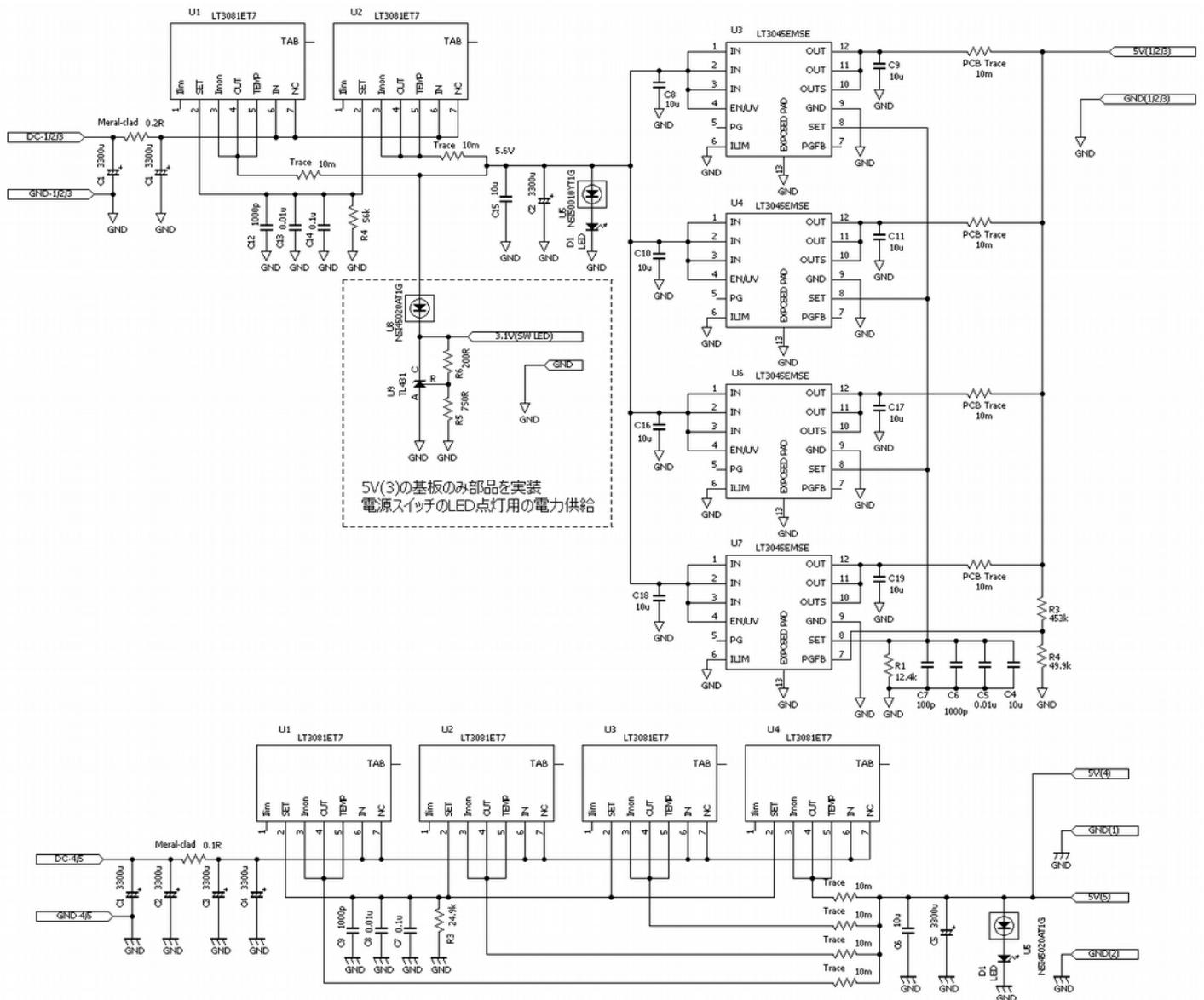
Low Noise Power Supply LHPS-2 回路図
