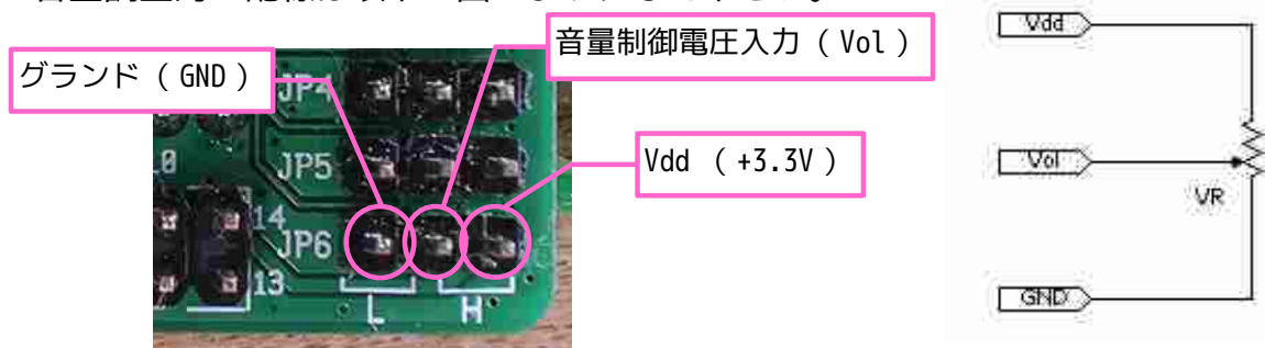
図 25 可変抵抗器の接続方法
