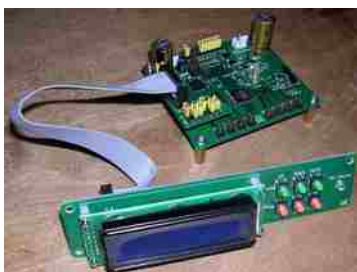
図 15 LCD & コントローラー基板とマイクロコントローラー基板の接続
