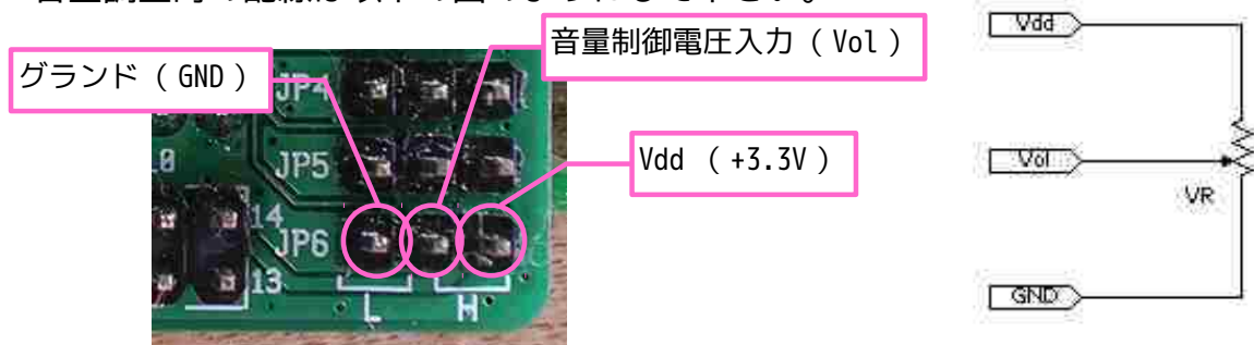
図 25 可変抵抗器の接続方法
