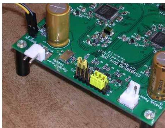
図7 ピンヘッダーを利用した接続例
