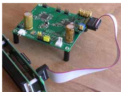
図12 LCD & コントローラー基板とマイクロコントローラー基板の接続
