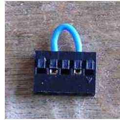
Reserved ピンのG-Dを短絡するための QI コネクタ
