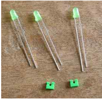
緑色の砲弾型 LED (3ミリ) 2.0 ピッチの短絡ジャンパー
