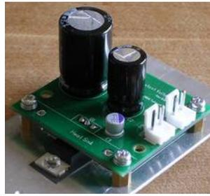
ケースの底板で放熱するように LM350 を基板裏面に実装していますが、基板表側に実装して放熱器をつけることも出来ます。
