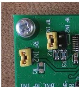
右の例は、BNC からの信号を有効としています。RF IN2 の信号入力端子を使用しない場合は、短絡ソケットでグランドに接続して、ロジック IC の入力がオープンにならないようにしてください。
