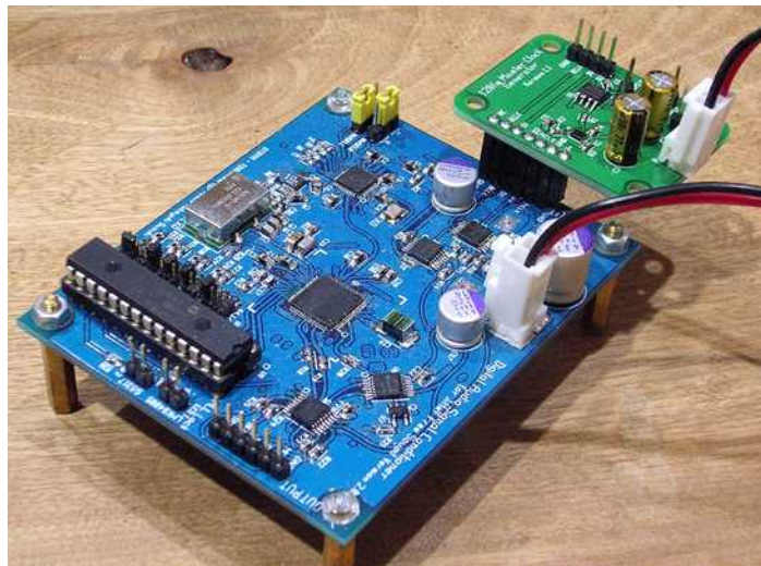
図4 Digital Audio Signal Conditioner 基板との接続例
